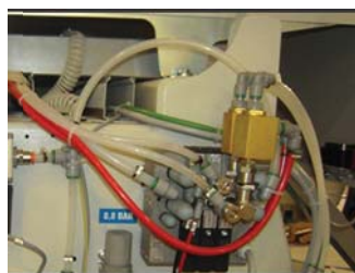
Пневоостров серии 2500 OPTUMA 32 в сверлильно-фрезерном станке с ЧПУ
