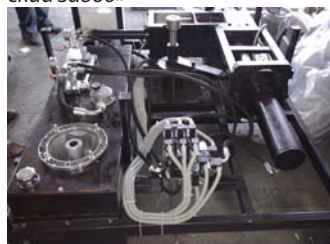
Гидропривод пресса для сращивания древесины по длине
