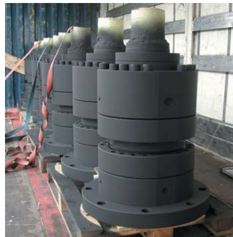
Гидроцилиндры шагающих балок
