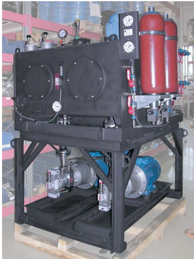
Гидростанция привода перемещения клетей прокатного стана
