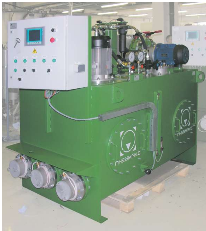
Станция смазки конвертера CTR-KV0882
