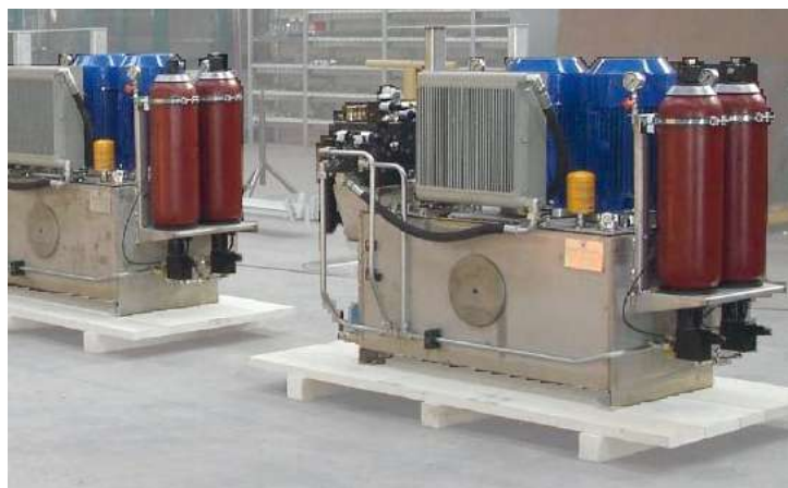
Гидростанции привода шиберных затворов
