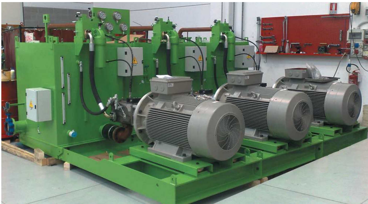
Гидростанция прокатного стана
