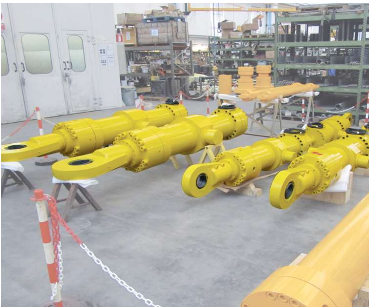
Гидроцилиндры прокатного стана
