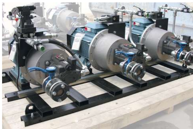
Мотор-насосные группы гидросистемы ДСП-25
