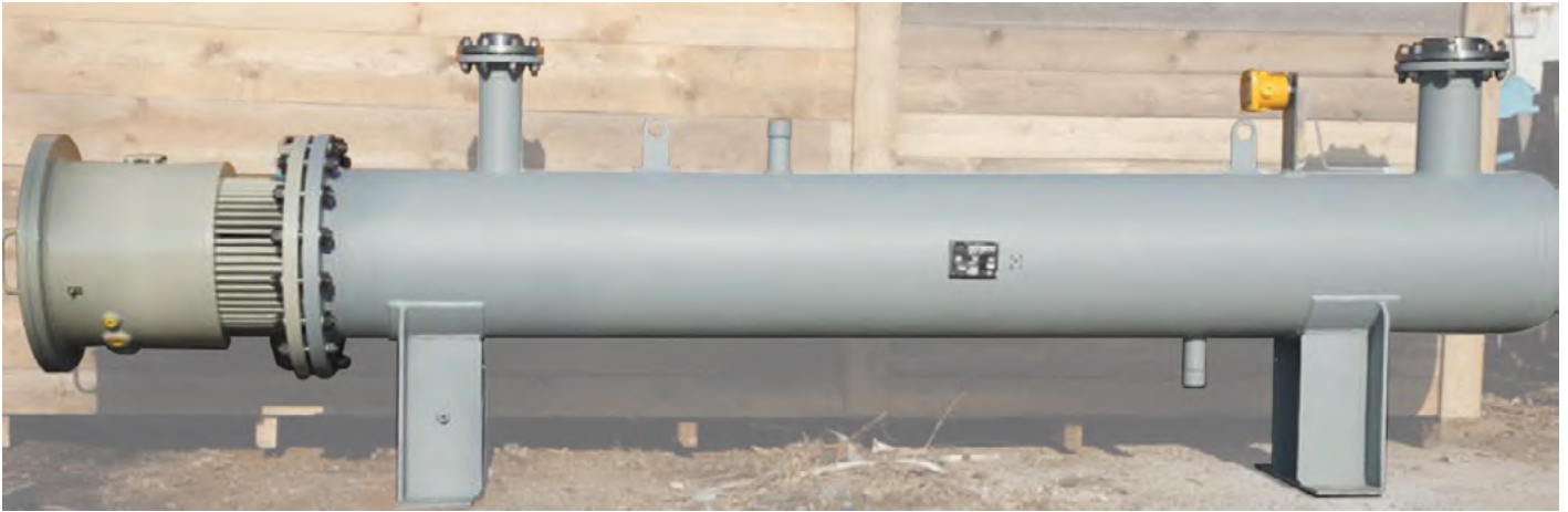
Циркуляционная система подогрева масла ПЖТ мощностью 75 кВт в баке объемом 32 м 3
