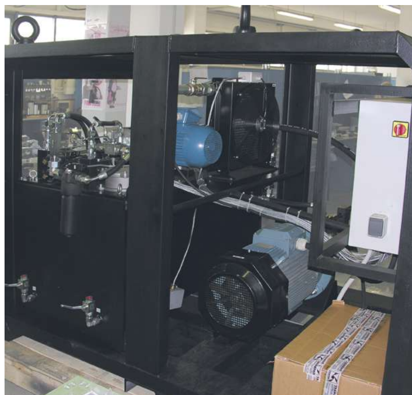
Гидростанция мобильного фрезерного станка CTR-KV0779
