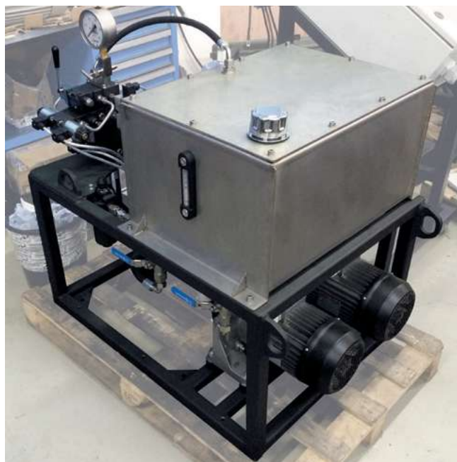
Гидростанция манипулятора с гидроподжимом защитного стакана в стальковше CTR-KV1131
