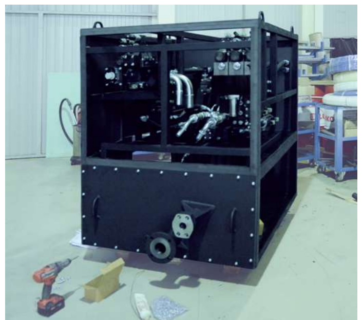
Гидропривод рулонно-вязальной машины CTR-KV1046
