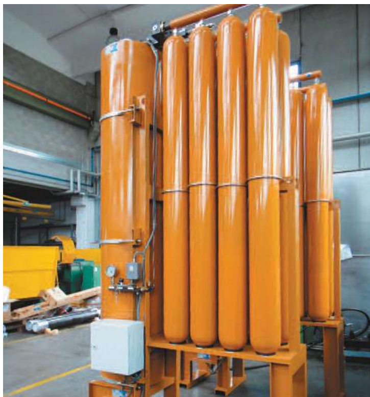
Пример аккумуляторной станции с поршневым аккумулятором и дополнительными газовыми баллонами
