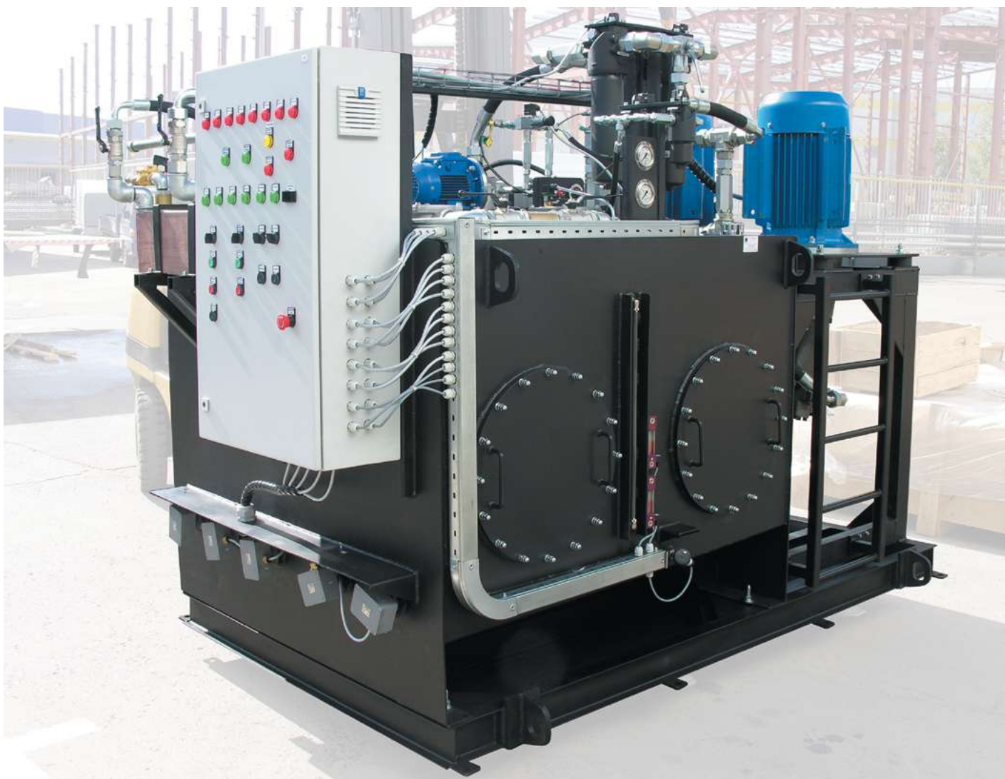
Гидростанция агрегата продольной резки листового проката CTR-KV1037
