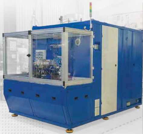
Стенд для испытаний компонентов электрогидравлической системы управления АКП CTR-KV-D0132
