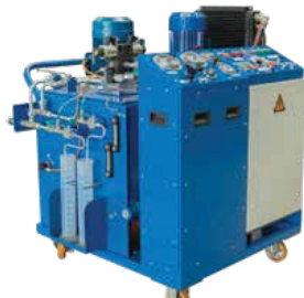
Мобильный модуль испытаний гидроцилиндров
