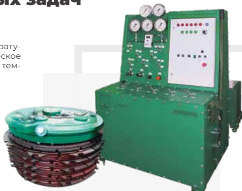
Стенд для промывки и прямо-сдаточных испытаний авиационных колесных тормозов Рабочая жидкость AMF-10
