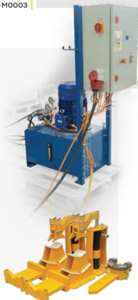
Опорные кронштейны с гидравлическим приводом зажима
