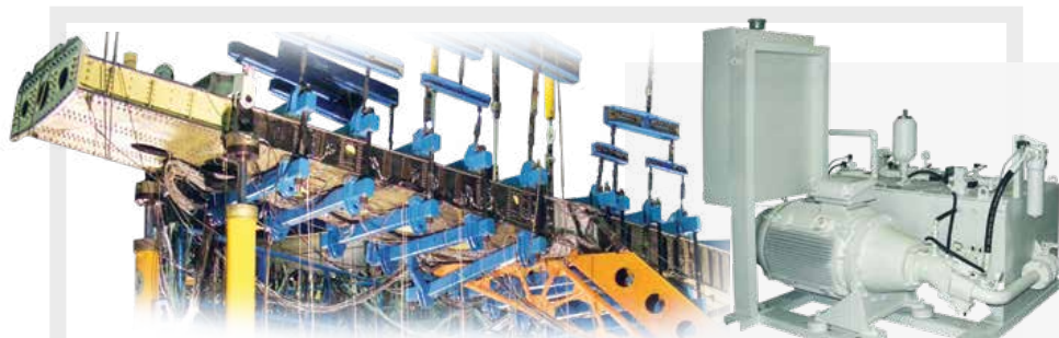
Гидравлическая насосная станция силовой установки гидросистемы, предназначенной для проведения прочностных и ресурсных испытаний авиационных конструкций
