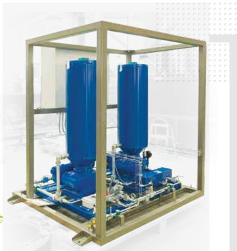
Станция пластичной смазки в установке непрерывной разливки стали CTR-KV-C0365
