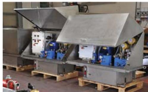
Насосная станция гидропривода шаровых кранов
