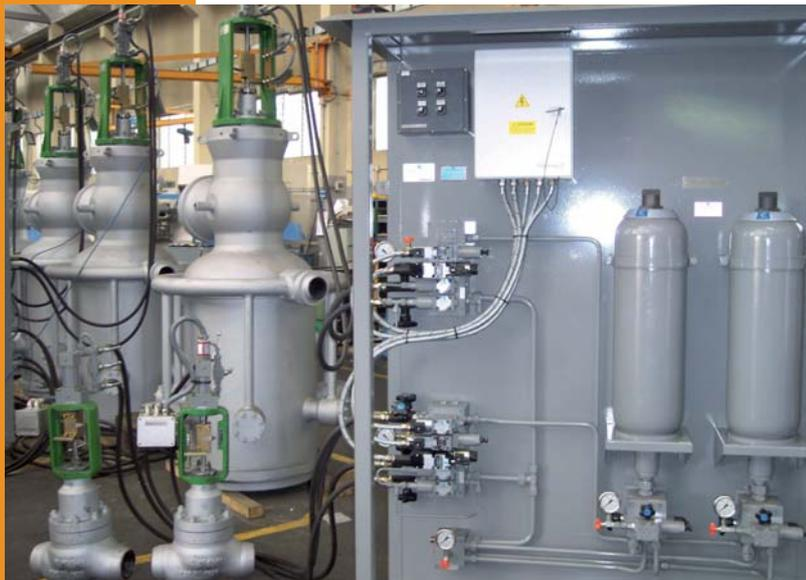
Сервоклапаны с гидравлической панелью управления
