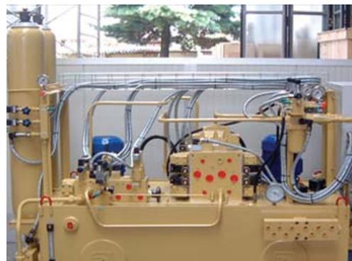
Гидроагрегат для управления водяной турбиной Фрэнсиса
