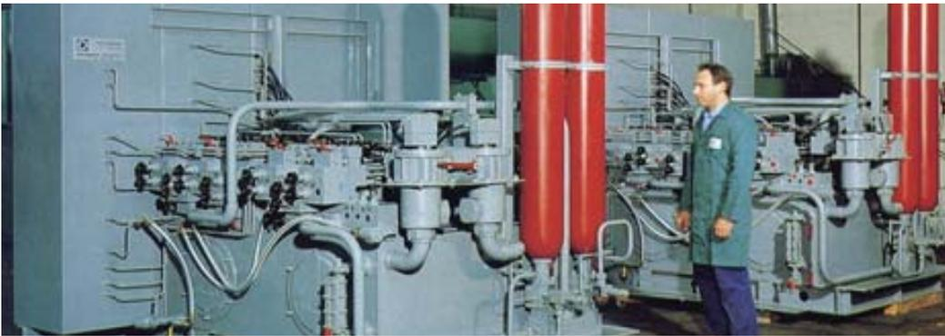
Насосная станция для привода задвижки
