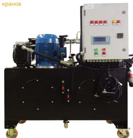
Испытательно-фильтрационный стенд для гидропривода шаровых кранов
