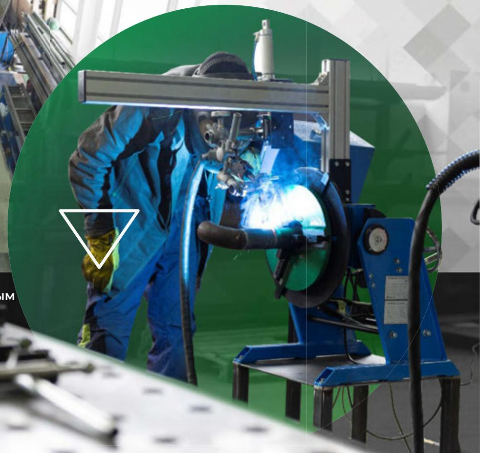
Сварочный участок, оснащенный современным полуавтоматическим сварочным оборудованием, позиционерами, сборочными стапелями и средствами механизации сварки
