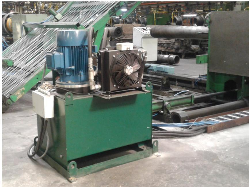
**Гидростанция CTR-KV-B0054 для станка для сборки покрышек СПД4**
