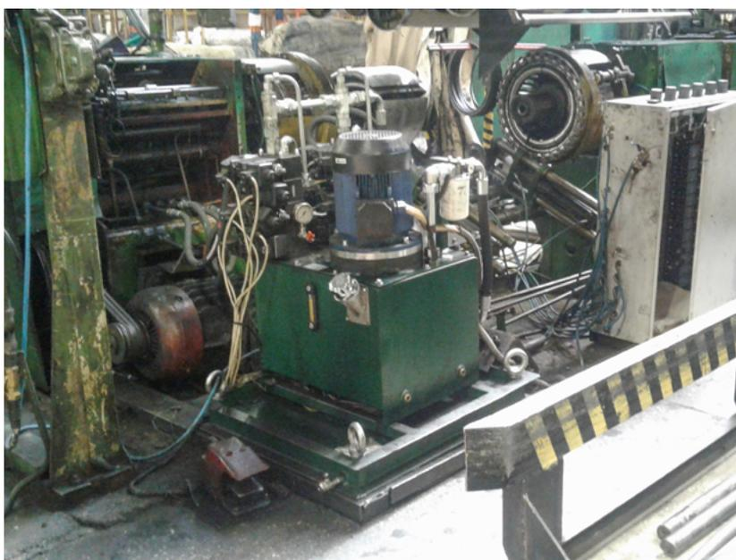
**Гидростанция CTR-KV1222 для станка для сборки покрышек СПД2**
