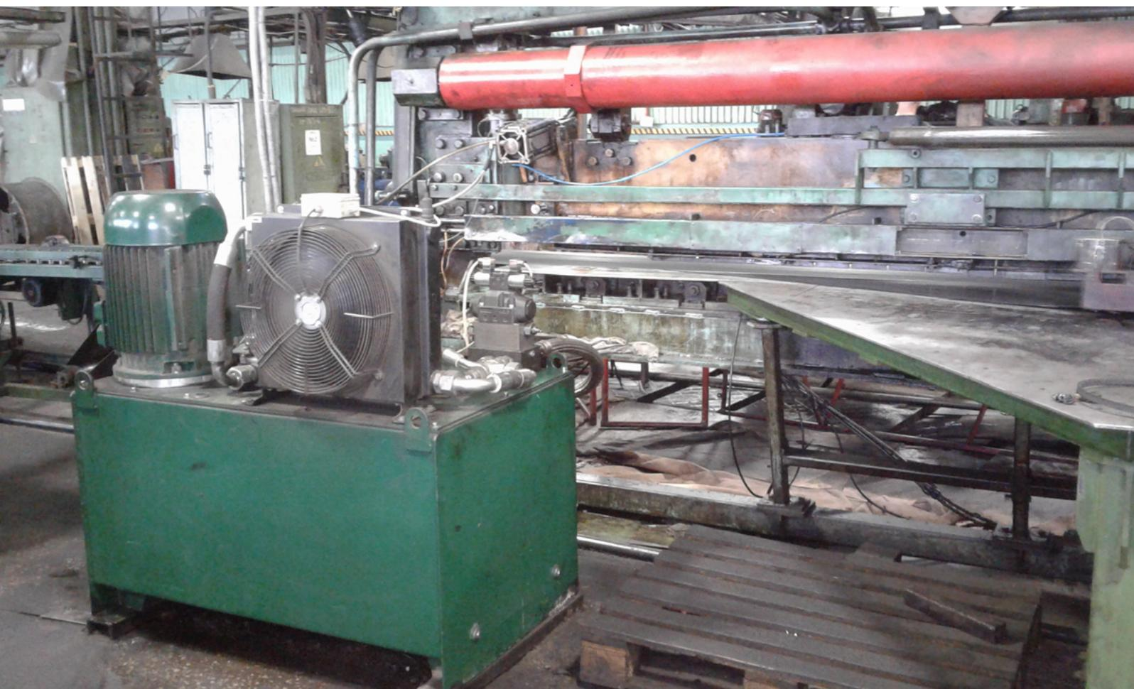
Гидростанции **CTR-KV-B0040** со станком для нарезки корда
