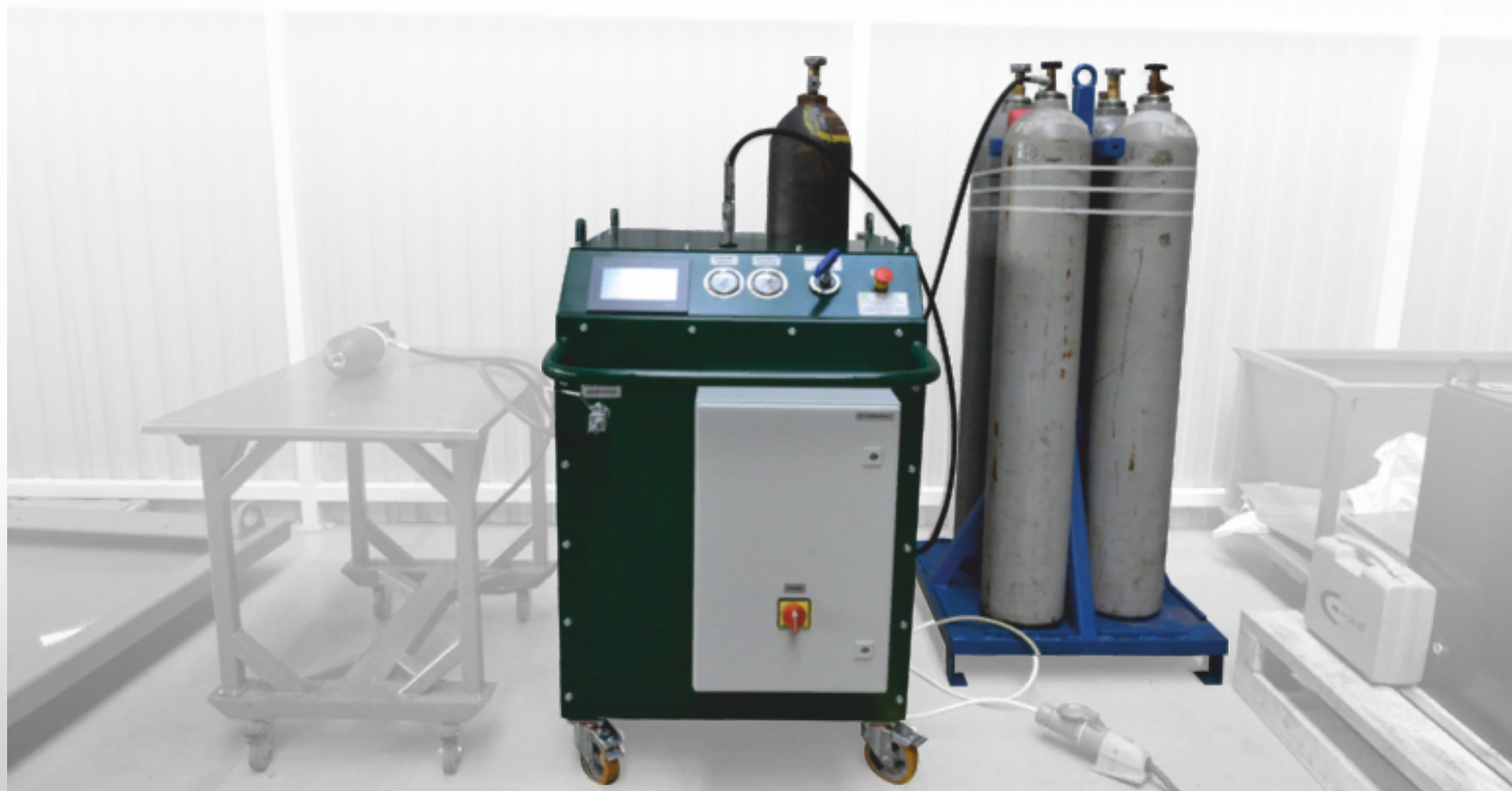
Процесс зарядки аккумулятора с применением станции CTR-KV2050-4-1
