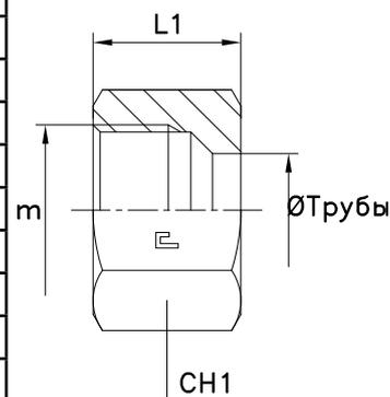
**ТРУБНЫЙ ФИТИНГ ПРЯМОЙ С УПЛОТНЕНИЕМ ИЗ ЭЛАСТОМЕРА (ЦИЛИНДРИЧЕСКАЯ РЕЗЬБА BSP)**
