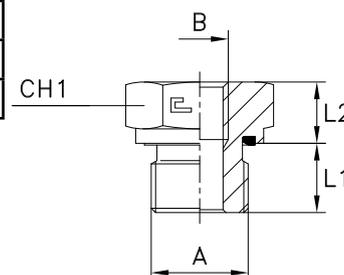
**ТРУБНЫЙ ФИТИНГ-ПЕРЕХОДНИК НАР.-ВНУТР. С УПЛОТНЕНИЕМ ИЗ ЭЛАСТОМЕРА (ЦИЛИНДРИЧЕСКАЯ РЕЗЬБА)**
