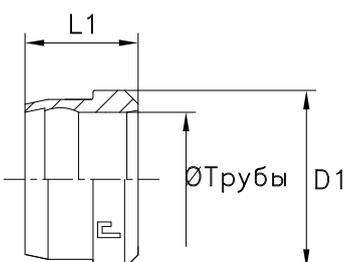
**ГАЙКА ОБЖИМНАЯ ДЛЯ ТРУБНЫХ СОЕДИНЕНИЙ**
