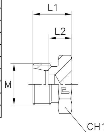
**РЕЗИНОМЕТАЛЛИЧЕСКОЕ КОЛЬЦО (ЦИЛИНДРИЧЕСКАЯ РЕЗЬБА BSP)**
