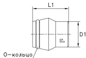
**ТРУБНЫЙ ФИТИНГ-ПЕРЕХОДНИК НАР.-ВНУТР. С УПЛОТНЕНИЕМ ИЗ ЭЛАСТОМЕРА (ЦИЛИНДРИЧЕСКАЯ РЕЗЬБА)**
