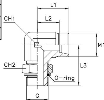
**ТРУБНЫЙ ФИТИНГ ПЕРЕХОДНИК (ЦИЛИНДРИЧЕСКАЯ РЕЗЬБА BSP)\***
