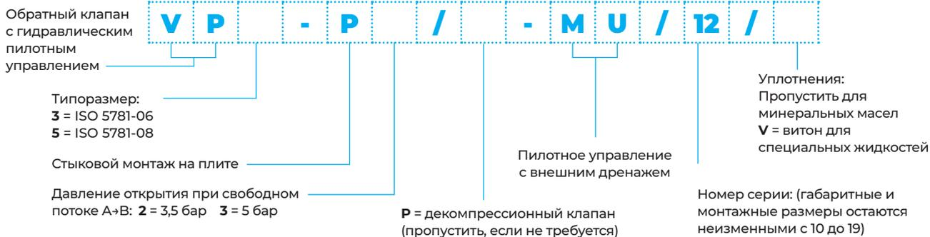
Пример кода для заказа: VP3-P3-MU/12 - Клапан обратный с пилотным управлением, СЕТОР 06, 320 Бар, 50 л/мин, давление срабатывания 5 бар.
